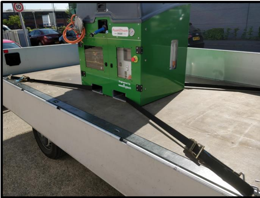
Figure 21 - Sanglage de la M600 au véhicule
